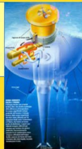
Energia dal gradiente termico (prototipo - Hawaii)
